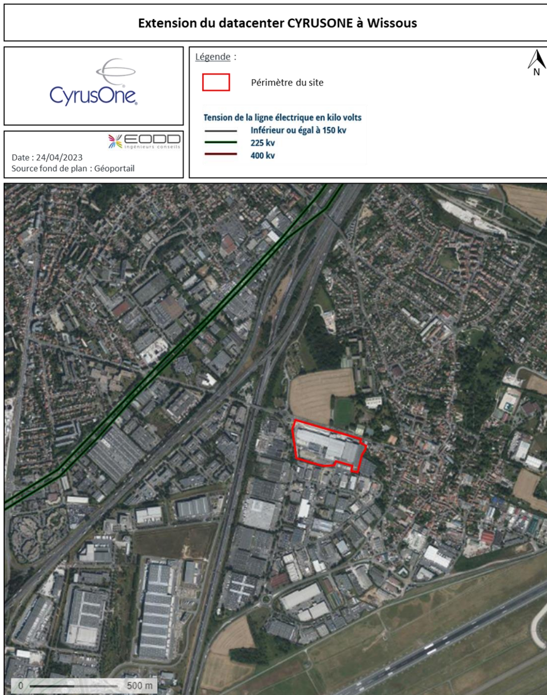
Figure 82 : Lignes électriques à proximité du site
